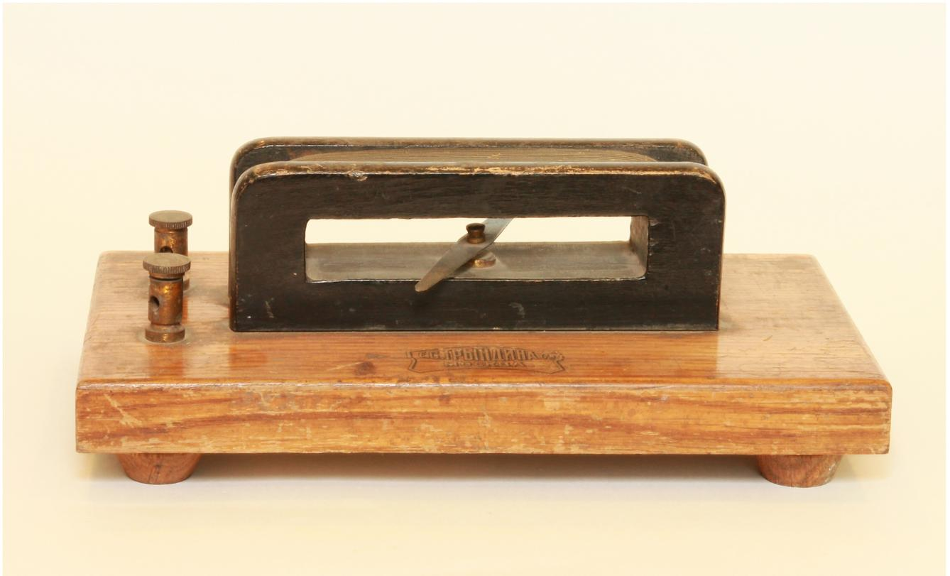
В 1821 году Поггендорф усовершенствовал конструкцию «мультипликатора», снабдив его измерительной шкалой.
