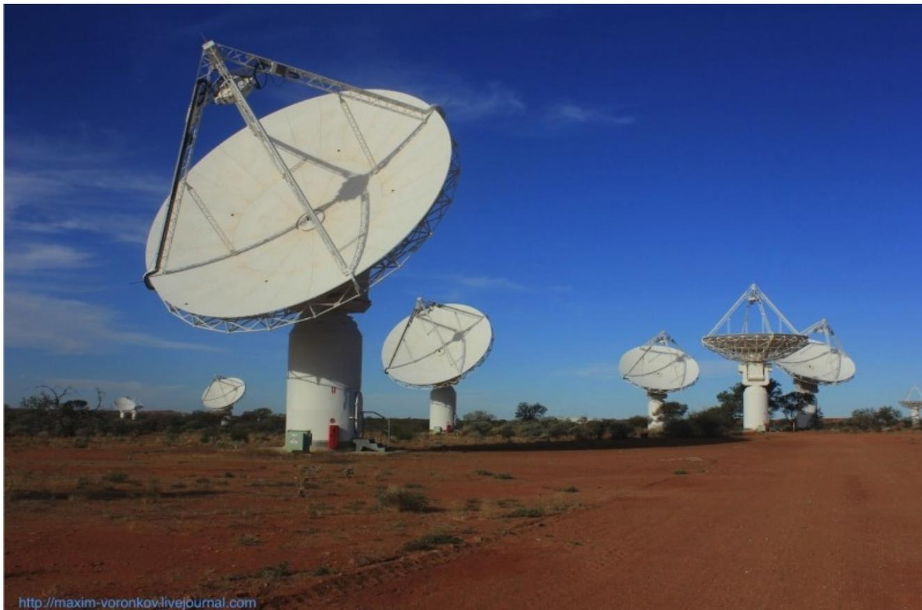
Инструмент ASKAP (на фото) в Западной Австралии является «прекурсором» для проекта SKA, там планируется задействовать до 36 двенадцатиметровых параболических антенн. На данный момент в строй введены только восемь из них. Тем не менее, даже с помощью небольшой части антенн удалось обнаружить быструю радиовспышку, используя большое поле зрения инструмента и новые чувствительные приёмники.
